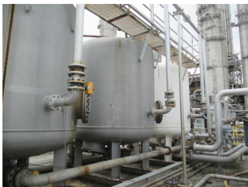
รูปที่ 3.1-2(24) Sand Filters
