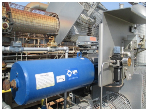
รูปที่ 3.1-2(84) Remote Shut-off Valve
